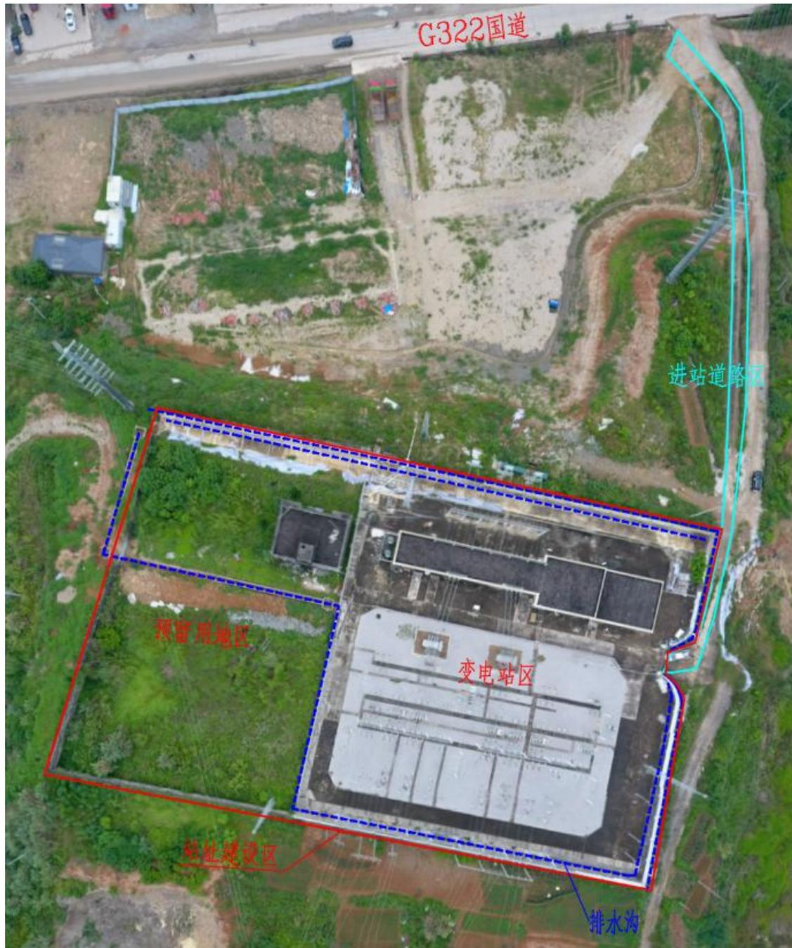
35kV 城西变电站（站区绿化、排水沟、雨水管、铺碎石、集水井）
