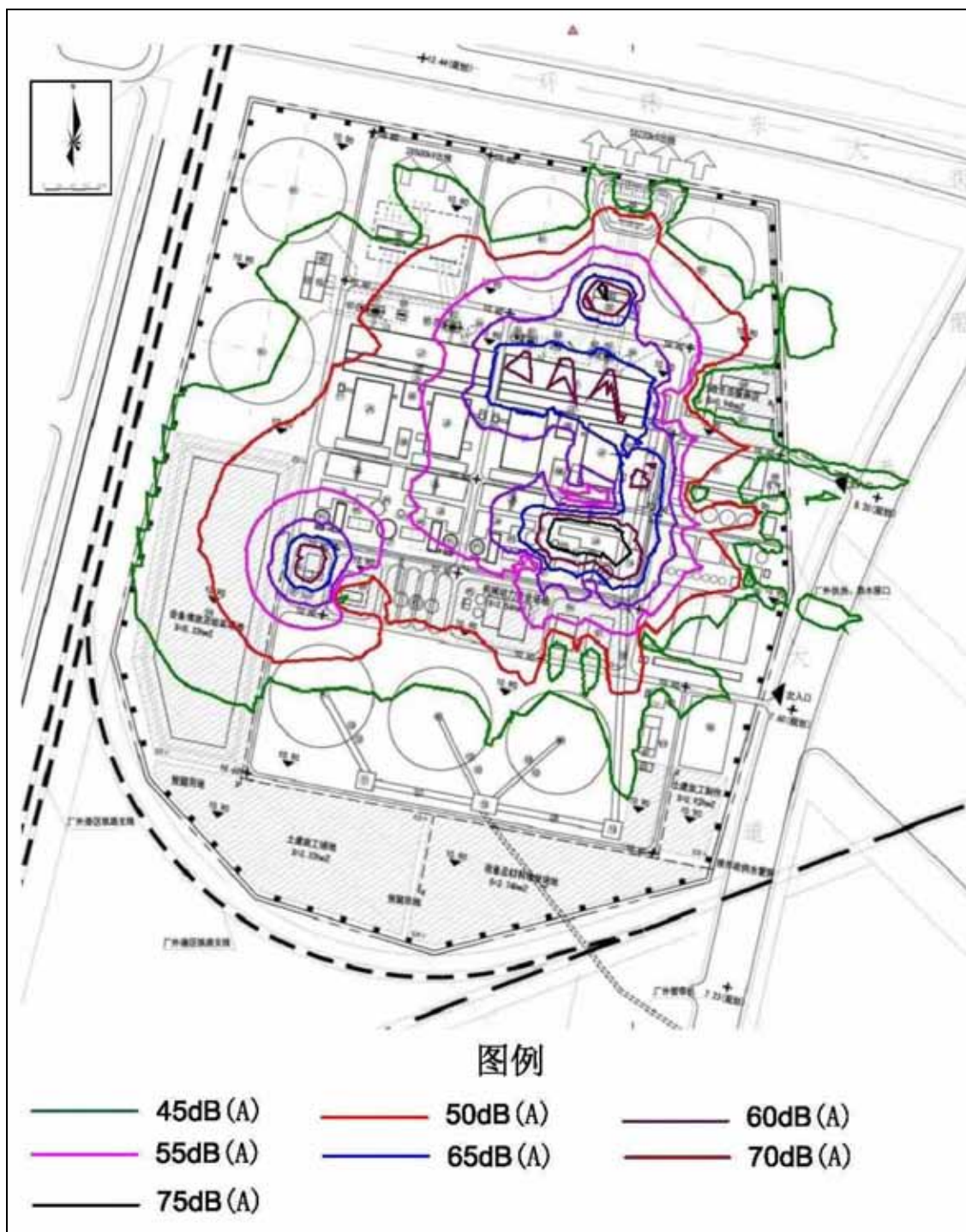
图 4.4-1 电厂噪声等声级线分布图（正常运行）
