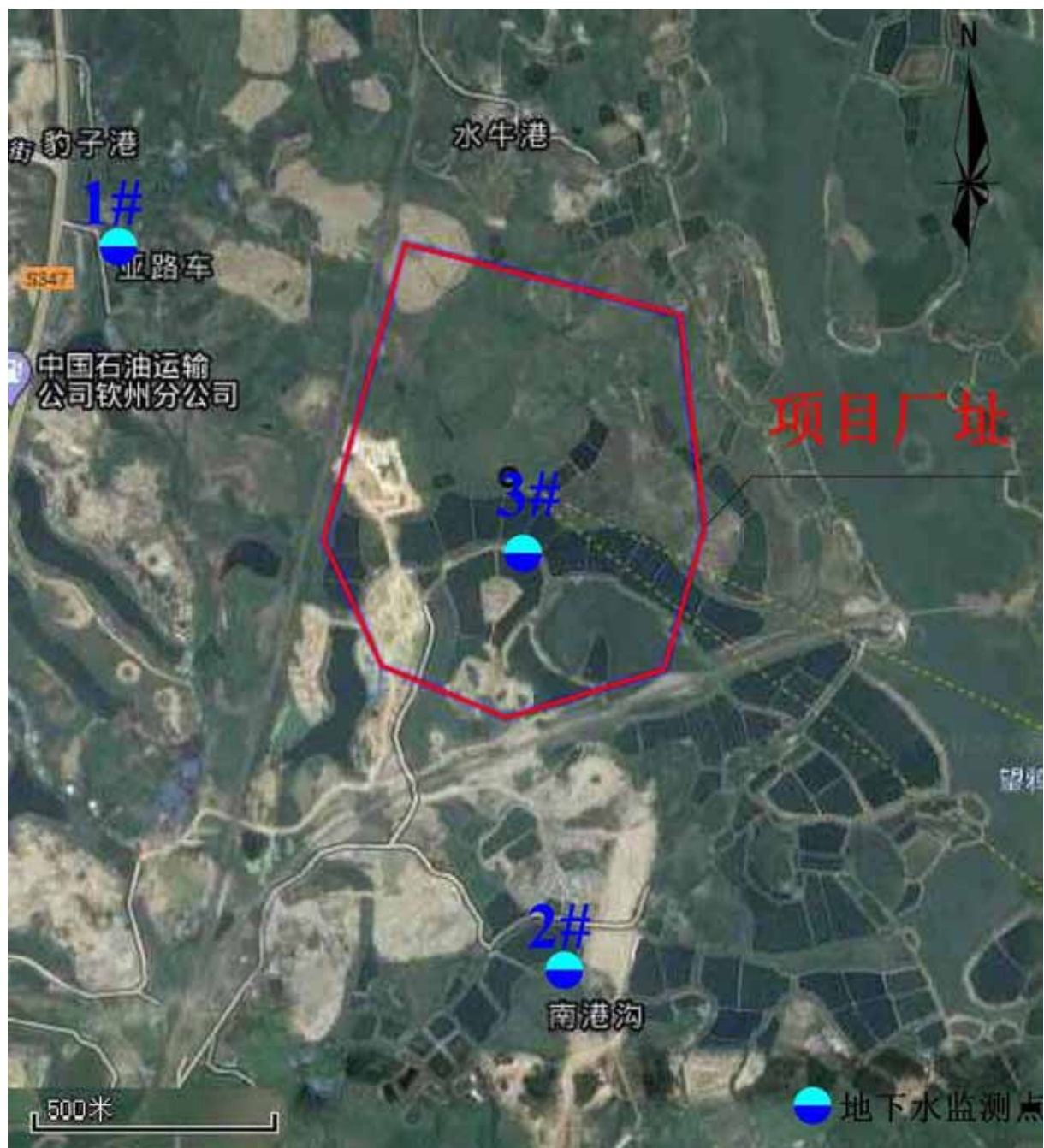
图 7.2-1 项目地下水环境监测布点示意图
