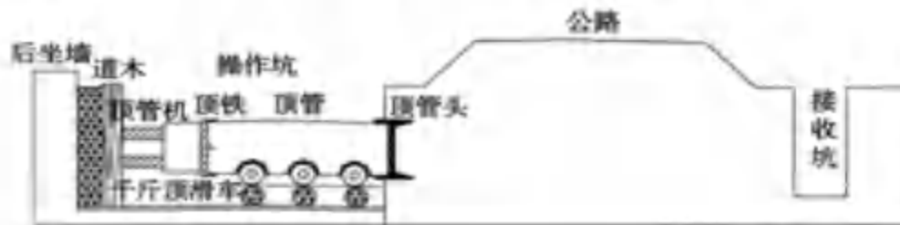
图 2.11-9 顶管施工工艺示意图
