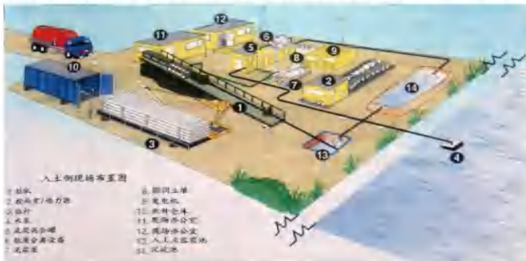
图 2.11-3 定向钻施工钻机场地平面布置图
