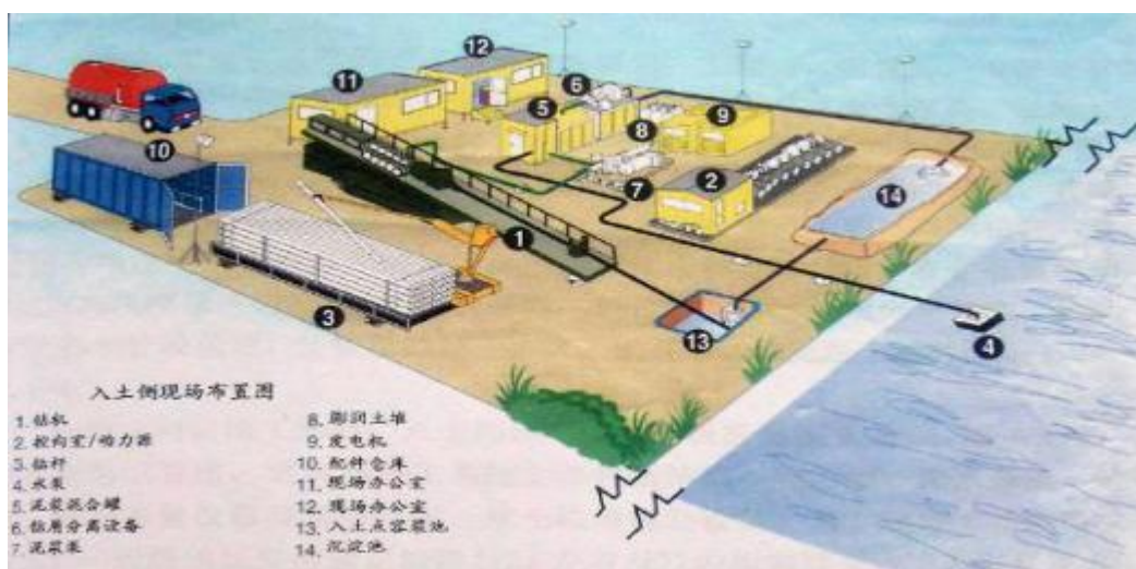
图 4.1-3 定向钻施工钻机场地平面布置图
